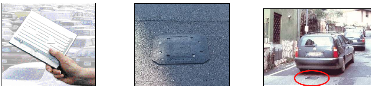
fig. 15 piastra Nu-Metrics NC 97 e posizionamento su strada
