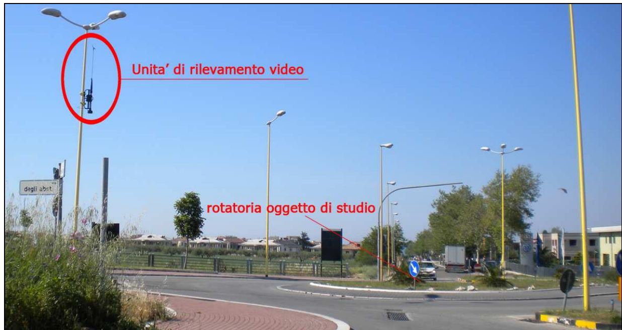
Figura 12: unità di rilevamento agganciata ad un palo della pubblica illuminazione per rilevamento rotatoria Con la tecnologia Miovision si sono effettuati i seguenti studi:
