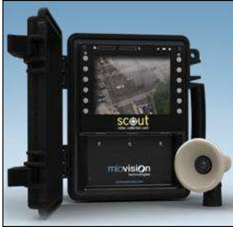
Figura 9: Unità di rilevamento con schermo LCD da 5,6" e obiettivo telescopico
